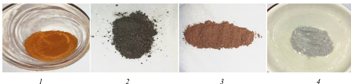
Рис. 1. Цветовые оттенки измельченного ЧСК, модифицированного: 1 — Fe (III); 2 — Co; 3 — Ni; 4 — ЧСК, измельчен на шаровой мельнице (фракция 0,3–7,0 мкм)
